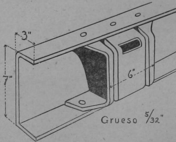
Está constituido de acero prensado con un grueso de 5/32 de pulgada y 7 pulgadas de ancho. Además tiene refuerzos fuertísimos incluyendo una plancha coraza de acero que cubre el tanque de gasolina, constituyendo el conjunto un chasis formidable que asegura larga vida.
